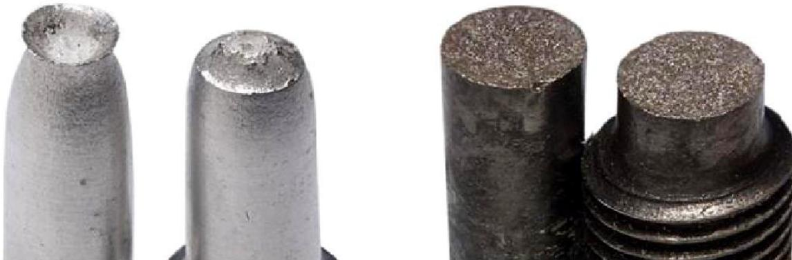
Вязкое разрушение типа чашечка и конус
